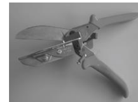
Tijeras de inglete desmultiplicadas Referencia: Janser: 262 284 000. Para cortar alrededor de las bases de los marcos de las puertas, zonas de difícil acceso.
